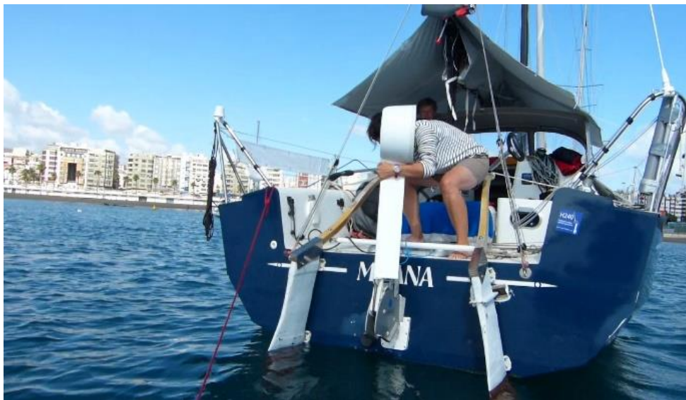
Mise en place du H240 dans sa platine d'accueil
